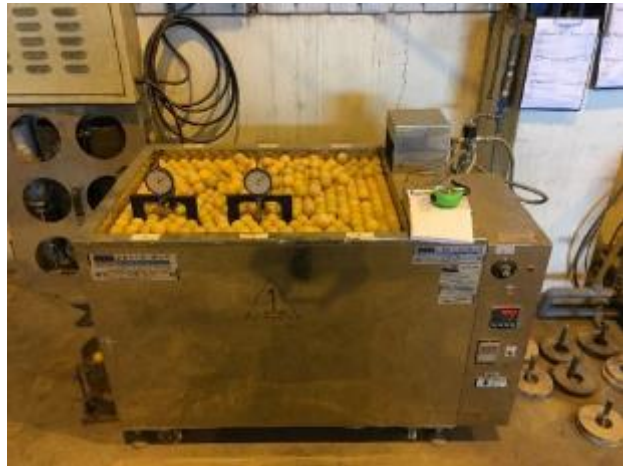
恆溫水槽 (量測體積變化)
