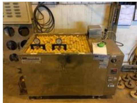
恆溫水槽 (量測體積變化)
