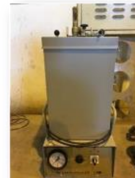
高壓蒸鍋 (熱壓膨脹試驗)
